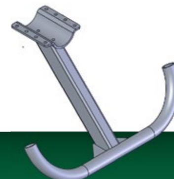
Flügelstütze für seitlich schwenken
