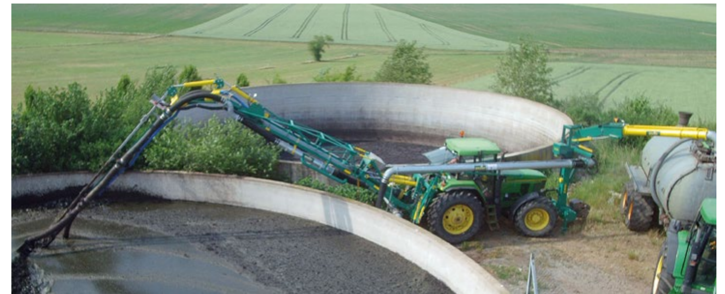
B70-10-60 J2Z Jet 1200 mit Frontbefüllung ohne Beruhigungstank
