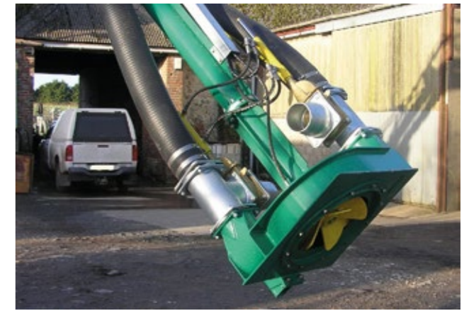
Gehäuse Jet 700 mit Rührdüsen
