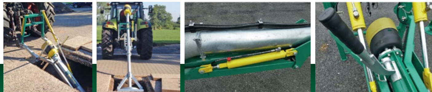
B04-65 L1Z mit Rührring eckig beim Einfahren in die Grube. Auf Wunsch mit hydraulischer Rührstangenschwenkung und automatischer Klinke.
