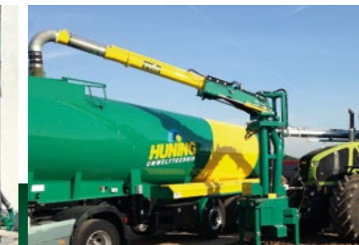
Frontbefüllung mit Beruhigungstank
