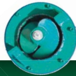
Laufrad Typ 2 aufgepanzerte WIDIA Reisskanten
