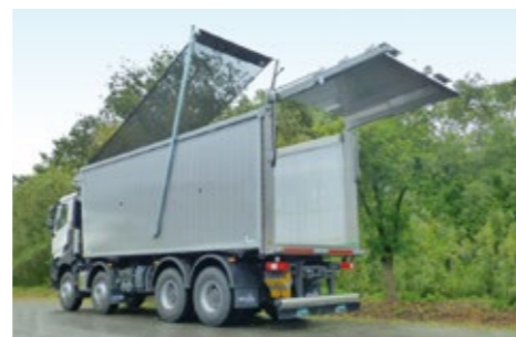
Abschiebewagen: Push Aufbau
