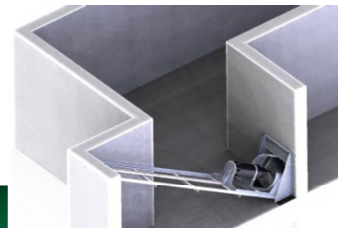
Variante A: mit Rührwerkskorb 700x700mm oder 625x625mm
